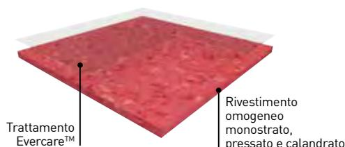
MIPOLAM ESPRIT è un pavimento omogeneo con un alto contenuto di PVC compattato, pressato disponibile in teli di 2m, con uno spessore di 2mm e peso di **≤ 2780g**.
