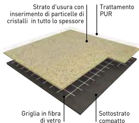
**TARASAFE STANDARD** è un pavimento in PVC privo di cariche, gruppo T di abrasione, compatto, (R10), disponibile in teli. È costituito da uno strato di usura in PVC puro con inserimento di particelle di cristalli minerali (brevetto in fase di approvazione) e di chip di PVC colorato di diverse dimensioni e diverso formato, accoppiato ad un substrato in PVC compatto, rinforzato con una griglia in fibra di vetro. È ecosostenibile e certificato Floorscore®.
