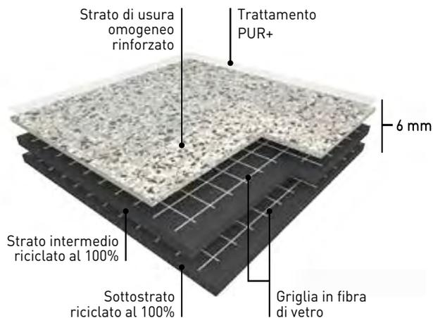
**GTI MAX** è una pavimentazione in PVC multistrato a posa libera con trattamento poliuretano (**PUR+**), spessore 6 mm, in piastre con incastri a coda di rondine nella configurazione **CONNECT** e a giunzioni saldate nella configurazione **CLEANTECH**.
