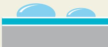
Il trattamento superficiale **Evercare** è idrorepellente e previene l'assorbimento delle sostanze (prodotti con base alcool Eosine e Betadine, gel idroalcolico, etc.) all'interno della pavimentazione. Queste sostanze rimangono sulla superficie e sono quindi facilmente pulibili.
