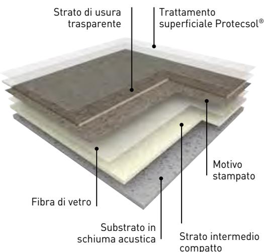
**TARALAY INITIAL COMFORT** è un pavimento vinilico multistrato, disponibile in teli da 2 m di larghezza (**Gruppo T** di abrasione). Il prodotto è dotato di sottostrato in schiuma ad altissima densità (VHD), rinforzato con fibra di vetro e provvisto di un motivo stampato e protetto da uno strato di usura trasparente (spessore: 0,65 mm). L'isolamento acustico è pari a 19 dB e la resistenza all'impronta è pari a 0,10 mm.
