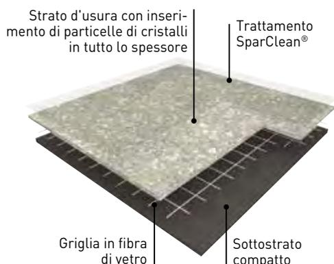
**TARASAFE GEO** è un pavimento in PVC antidrucciolo (R10), gruppo T di abrasione, dotato di isolamento acustico al calpestio, disponibile in teli. È costituito da uno strato di usura in PVC puro con inserimento di particelle di cristalli e di grani in PVC colorato di diverse dimensioni e diverso formato, associato ad un substrato in PVC compatto, rinforzato con una griglia in fibra di vetro.
