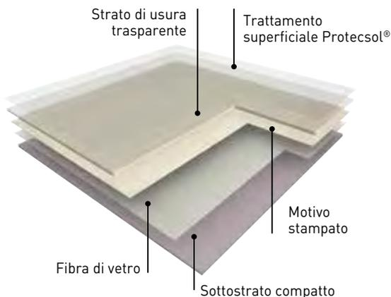
**TARALAY INITIAL COMPACT** è un pavimento vinilico multistrato, disponibile in teli da 2 m di larghezza (**Gruppo T** di abrasione). Il prodotto è dotato di sottostrato in schiuma ad altissima densità (VHD), rinforzato con fibra di vetro e provvisto di un motivo stampato e protetto da uno strato di usura trasparente (spessore: 0,65 mm). L'isolamento acustico è pari a 19 dB e la resistenza all'impronta è pari a 0,10 mm.
