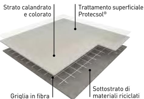
**MURAL ULTRA** è un rivestimento murale vinilico in strisce, con spessore di 1,5 mm a garanzia di lunga durata. La classificazione di reazione al fuoco Bs2d0 (En 13501-1) è conforme alla maggior parte delle norme antincendio europee. La superficie del rivestimento è realizzata in PVC colorato, mentre il sottostrato è composto al 25% di materiali riciclati.
