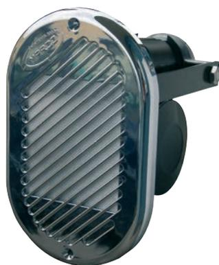
Tromba elettropneumatica ad incasso con eccezionale potenza sonora. Compressore integrato alla tromba. Immediata emissione del suono con la pressione del pulsante. Griglia in ASA e staffa in acciaio inox. Adatta per imbarcazioni da trasporto, professionali, gommoni e yacht sotto i 12 metri. Mascherina mm. 195x95
