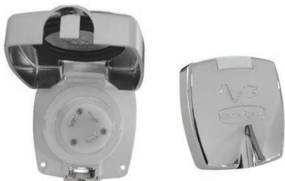
Presca con corpo in Luran resistente UV, copertura posteriore protezione cavi, contatti in ottone argentato. Spina in policarbonato + Moplen con sistema blocca cavo e contatti in ottone argentato. Voltaggio 220/110. Amperaggio max 30A.
