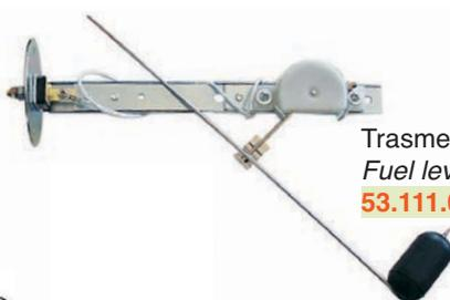
Trasmettitore livello carburante Ohm 10-180 Compatibile strumenti VDO
