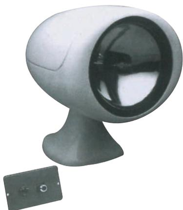
Proiettore orientabile "JABSCO SL 155" costruito con materiali anticorrosivo - di facile installazione - tramite il movimento della lampada alogena ha una escursione di 75° in verticale e 320° in orizzontale. Unità di comando in dotazione con cavo da 4,5 mt. Dimensioni: mm.160x200x200. Alimentazione 12 V.
