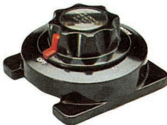
Scambiabatteria - Permette di usare alternativamente o insieme o staccare le batterie. Provvisto di rotore a scatto di sicurezza. Sopporta 175 A. a 12/24 Volt in C.C. e 300 A. in C.A. per 15 secondi. Dim. mm. 133 x 133
