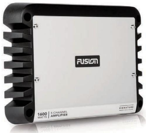
SG-DA51600 è un amplificatore a 5 canali Class-D Hi-Fi Marine, con una potenza massima di 1600 Watt: il vantaggio fondamentale di un amplificatore in classe D è il basso consumo della batteria mantenendo una potenza elevata, questo rende quest'amplificatore perfetto per l'ambiente marino. Lo chassis dell'amplificatore è un dissipatore di calore, perchè riducendo la temperatura interna del componente ne aumenta di conseguenza l'efficienza.
