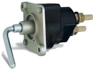
Staccabatteria in ottone e bachelite con contatti in ottone e rame argentati. 24 Volt - 2500 Amp. per 5 secondi - Capacità 250 Amp.
