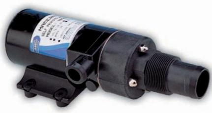
Maceratore **JABSCO** per serbatoi acque nere. Alta potenza - Autoadescante. Può scaricare serbatoi da 600 litri in continuo - autoadescante fino a mt. 1,2. Entrata 1 1/2" - 2" - Uscita 1". Dim. mm. 274x97x114.
