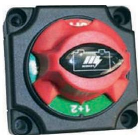
Scambiabatteria con manopola rotante - Permette di usare alternativamente o insieme o staccare le batterie. Provvisto di rotore a scatto di sicurezza. Sopporta 300 A. a 12/24 Volt in C.C. e 1000 A. per 5 secondi. Dim. mm.67 x mm. 67.
