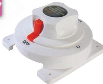
Scambiabatteria - Permette di usare alternativamente o insieme o staccare le batterie. Provvisto di rotore a scatto di sicurezza. Sopporta 175 A. a 12/24 Volt in C.C. e 300 A. in C.A. per 15 secondi. Dim. mm. 133 x 133
