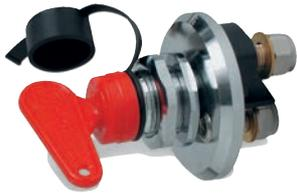
Staccabatteria con chiave estraibile, costruito in materiale plastico nero ed ottone cromato - Fissaggio su flangia da  $\varnothing$  mm. 70 - 2000 A per 3 sec. In Continuo 140 A
