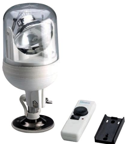
Proiettore orientabile radiocomandato, stagno. Ha un movimento orizzontale di 360° e verticale di 260°. Cupola in policarbonato ad alta resistenza meccanica e termica. Portata circa 350 mt. Completo di lampada, radiocomando e base di supporto con spinotto.
