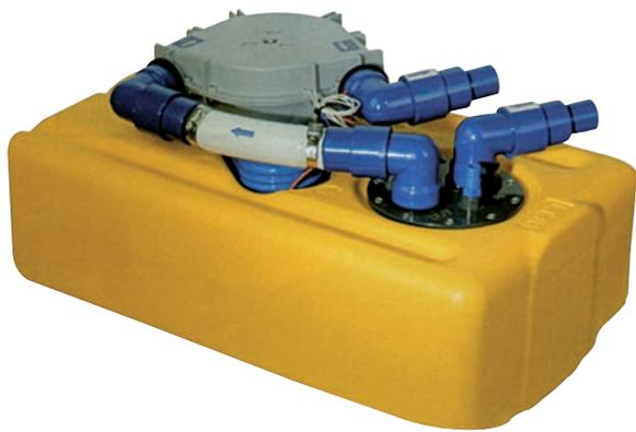
Serbatoio acque nere e grigie, completo di impianto per lo svuotamento con pompa autoadescante. Alimentazione 12 Volt - Aspirazione da vuoto a mt. 5 di profondità - Prevalenza verticale mt. 3
