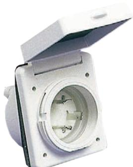
Presca con corpo in Luran resistente UV, copertura posteriore protezione cavi, contatti in ottone argentato. Spina in policarbonato + Moplen con sistema blocca cavo e contatti in ottone argentato. Cappuccio proteggi spina in PVC con ghiera a rotazione rapida in Luran resistente UV. voltaggio 220/110. Amperaggio max 30A.
