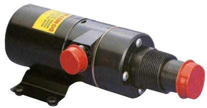
Maceratore **TMC** per serbatoi acque nere. Alta potenza - Autoadescante a grande prevalenza. Portata 50 lt/min. Entrata 1 1/2" - Uscita 1". Dim. mm. 274x97x114.
