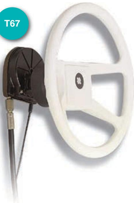
Gruppo timoneria «T67» dotato di frizione. Caratteristiche tecniche: Estremità del monocavo in acciaio inossidabile. Costruita in materiali resistenti alla corrosione marina - Frizione di serie regolabile esternamente e installazione a 90° con coprimozzo nero - Il gruppo timoneria può essere montato in 4 posizioni differenti per permettere l'uscita del cavo nella direzione più conveniente. Utilizza monocavi M58. Impiego: imbarcazioni con motore fuoribordo di potenza fino a 62 kW (85 cv)
