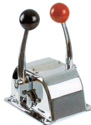
Scatole di comando bileva ad azione singola: ogni leva controlla separatamente il cavo del gas o dell'invertitore. Adatte a qualsiasi tipo d'imbarcazioni con motore fuoribordo, entro bordo e gruppi poppieri provvisti d'invertitore idraulico. Leve dritte, cromate.
