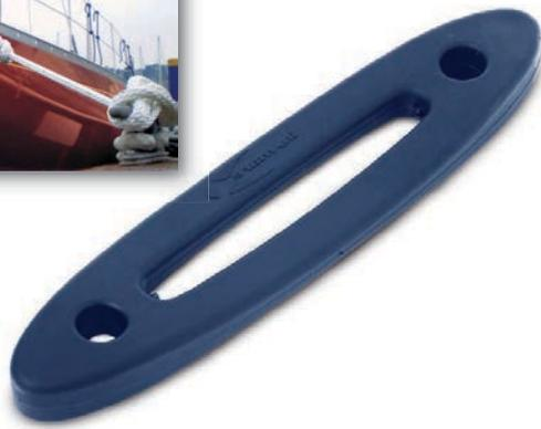
Molle di Ormeggio Compensa gli strappi a cordami e bitte, evitando all'imbarcazione e all'attrezzatura i danni provocati dal moto ondoso. Semplicissima da montare, sufficienti due nodi senza necessità di tagliare la cima. Realizzata in un particolare materiale termoplastico che garantisce elevate doti di elasticità e resistenza nel tempo agli agenti atmosferici.
