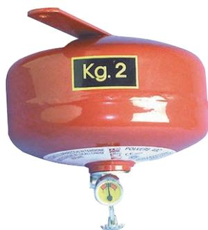
**ESTINTORE AUTOMATICO "A POLVERE" CON MANOMETRO PER VANO MOTORE.** L'automatismo si ottiene con un elemento termosensibile costituito da una ampollina di quarzo, contenente un liquido speciale, tarata ad una temperatura prefissata — normalmente tra 70 e 75° — provocando l'entrata in funzione automatica dell'estintore. Classe di fuoco A-B-C. Certificati **CE**
