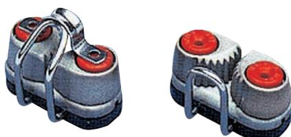
Strozzascotte a ganasce su sfere (senza ponticelli) realizzato in una speciale lega leggera anodizzata - Può essere utilizzato con scotte da mm. 5 a mm. 14 - Fori di fissaggio mm. 5 - Interasse mm. 38 - Altezza mm. 26 - Larghezza mm. 30 - Carico massimo di lavoro kg. 130
