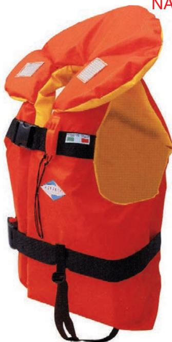
**GIUBBOTTO DI SALVATAGGIO A GIACCA. Life vest jacket.** Facile da indossare e da mantenere aderente al corpo. E' fabbricato in tessuto resistente ad alta visibilità, è dotato di colletto ergonomico, nastri retroriflettenti, fischietto omologato, sistema di regolazione di nastri e cinghie da mm 40 con relative fibbie a sgancio rapido, cordino e sottogamba regolabile. Disponibile in differenti taglie.
