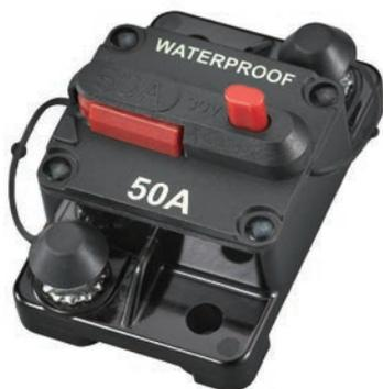
**L'INTERRUTTORE AUTOMATICO MAGNETOTERMICO** è una protezione termica specifica per correnti continue. Interviene in caso di sovrarisaldamento del circuito elettrico. Il riarmo della protezione è manuale. Può essere utilizzato fino a 42 Vdc. Montaggio da appoggio. Dim. mm. 74 x 49
