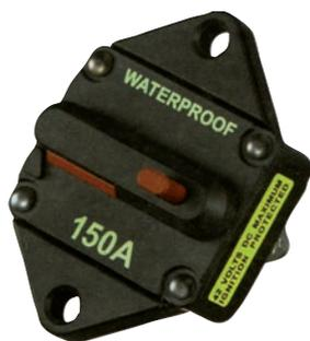
**L'INTERRUTTORE AUTOMATICO MAGNETOTERMICO** è una protezione termica specifica per correnti continue. Interviene in caso di sovrarisaldamento del circuito elettrico. Il riarmo della protezione è manuale. Può essere utilizzato fino a 42 Vdc.
