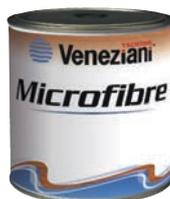
**MICROFIBRE - Microfibre sintetiche** della lunghezza media di 500 micron che, miscelate alla RESINA 2000, ne rinforzano la struttura creando all'interno del composto un'armatura multidirezionale, ed essendo a basso assorbimento, non alterano le caratteristiche di penetrazione della RESINA 2000 nel supporto. Servono per incollaggi strutturali tipo "fillet" (per incollare giunti a "T") dove si richiede uno stucco strutturale ad alta densità e forte struttura.
