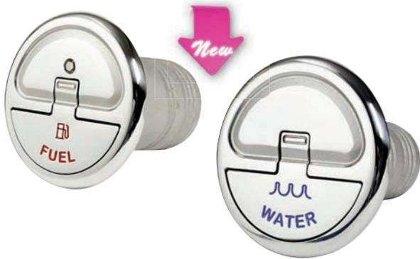
Tappi di imbarco con chiusura a scatto con rotazione 45°; sporgenza solo 7,7 mm; viti a scomparsa; cavetto inox di ritengo con molla; versioni fuel e diesel con attacco per cavo di massa; fabbricato in acciaio inox AISI 316 lucidato a specchio; simbologia a norme DIN.
