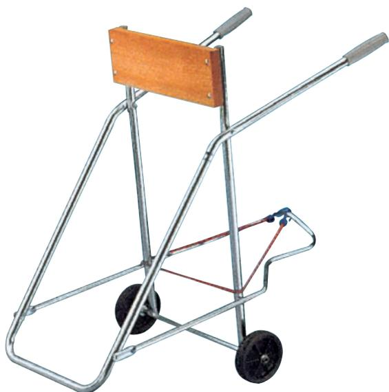
Carrello portamotore pieghevole, fabbricato con tubo in acciaio zincato con portaserbatoio per motori fino a 25 HP e tavoletta in legno da 38 cm. di larghezza. provvisto di ruote in gomma maniglie e portaserbatoio con molla di fissaggio.
