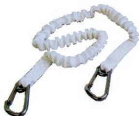
Cinghia elastica ombelicale per cinture di sicurezza, provvista di due moschettoni inox. Lunghezza cm. 100, in trazione cm. 190. Fabbricata con cinghia in nylon tubolare e completa di elastico di recupero per garantire la movimentazione in sicurezza durante la navigazione.
