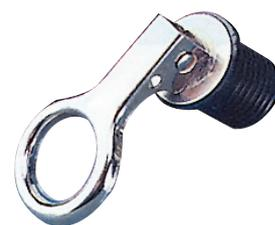
Tappo a espansione a vite regolabile in acciaio inox e gomma neoprenica. La regolazione avviene mediante la rotazione del traversino filettato. Espansione da mm. 22 a mm. 26.
