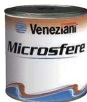
**MICROSFERE - Microsfere di vetro cave** a basso assorbimento di umidità e quindi possono essere impiegate per applicazioni sopra e sotto la linea di galleggiamento. Servono per ottenere una gamma di stucchi a basso peso specifico, facilmente carteggiabili, la cui consistenza è variabile a seconda della necessità dell'operatore. Ideale per il riempimento di fessurazioni orizzontali, piccole imperfezioni superficiali, stuccature rasare e cordonature.
