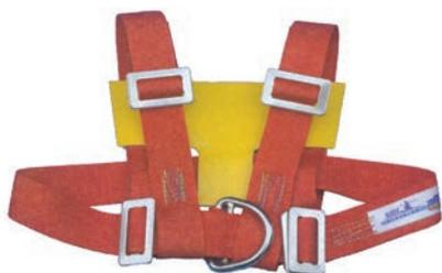
Cintura di sicurezza Junior 50, conforme alla direttiva 89/686 EEC. Fabbricata in cinghia di poliestere ad alta resistenza con fibbia in acciaio inox ad innesto rapido. Provvista di schienale. Adatta alle persone di peso tra i 20 ed i 50 kg. Certificata a norme EN 1095. Taglia torace 40-80 cm. Mod. ragazzo.
