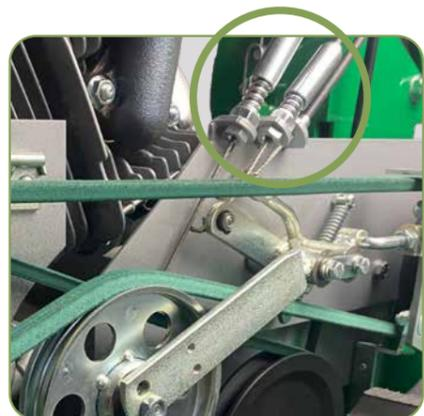
Compensatori di tiro per la regolazione automatica del tendicinghia così da evitare gli slittamenti della stessa. Questo permette un maggior controllo visivo della regolazione dei registri.
