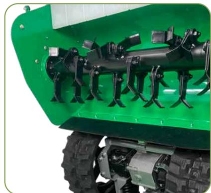
Rotore con quattro sezioni di coltelli sfasati in acciaio per ottimizzare la lavorazione e minimizzando l'assorbimento di potenza del motore quindi garantendo un minor consumo
